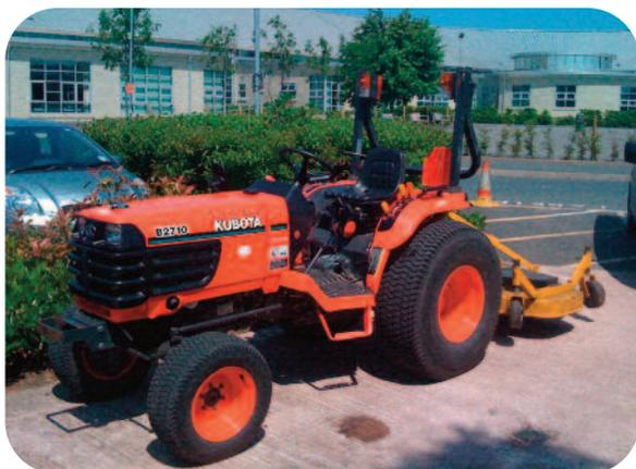
*Tracteur 27 cv équipé d'une débroussailleuse*
