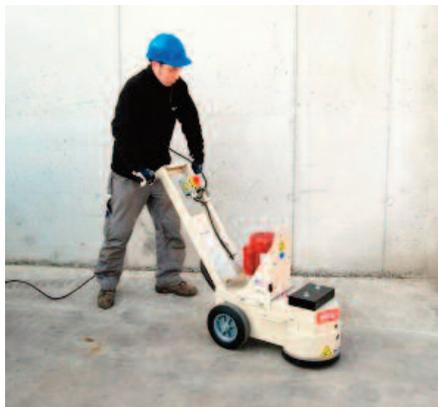
*Ponceuse à béton*
