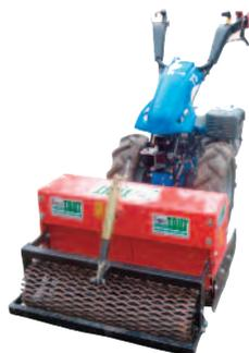
Désherbeur mécanique sur motoculteur
