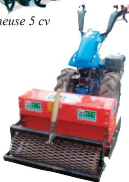
Motoculteur équipé d'un désherbeur mécanique
