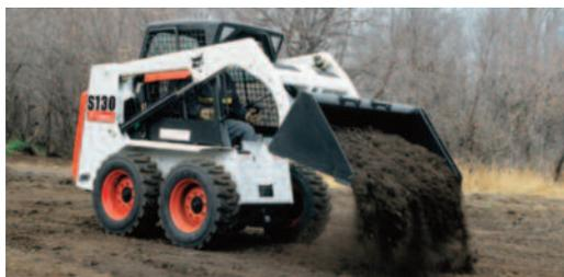
Chargeuse compacte sur pneus 2,4 tonnes
