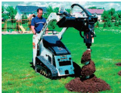
Tarière hydraulique sur mini chargeuse
