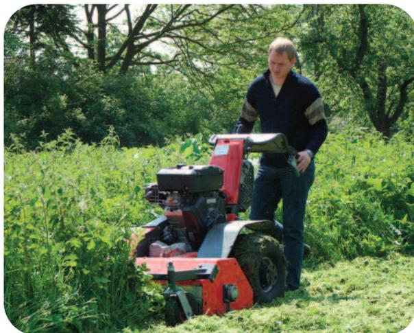
Débroussailleuse 16 cv à fléaux
