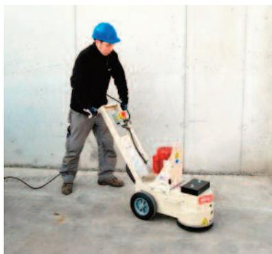
*Ponceuse à béton*
