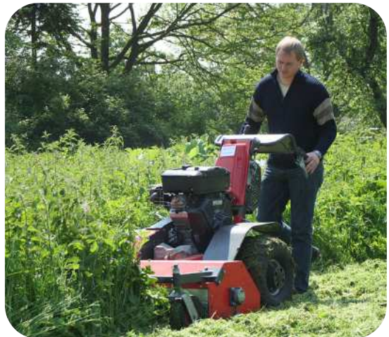
Débroussailleuse 16 cv à fléaux
