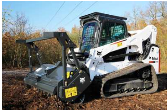
Débroussailleuse forestière sur chargeuse 518
