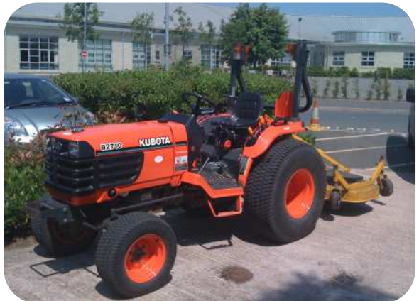
Tracteur 27 cv équipé d'une débroussailleuse
