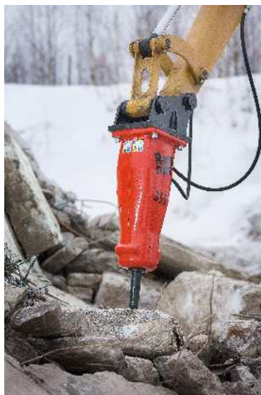
Brise béton sur mini-pelle 2t5
