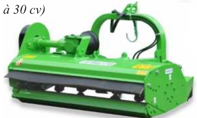
Débroussailleuse à marteaux (pour tracteur 30 à 45 cv)
