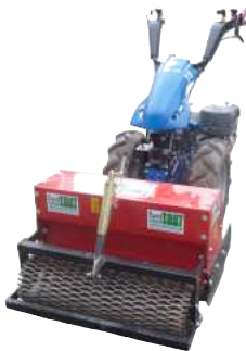
Désherbeur mécanique sur motoculteur
