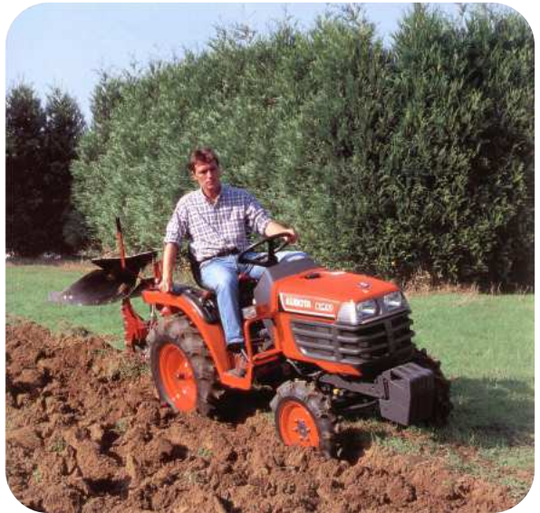
Tracteur 14 cv équipé d'une charrue
