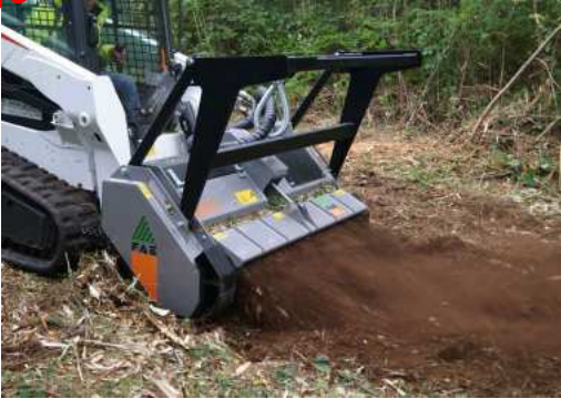
Débroussailleuse forestière sur chargeuse 217
