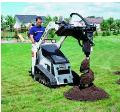
Tarière hydraulique sur mini chargeuse
