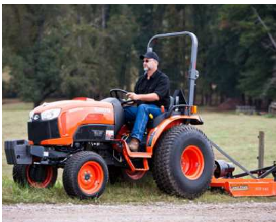
Tracteur 24 cv équipé d'une débroussailleuse
