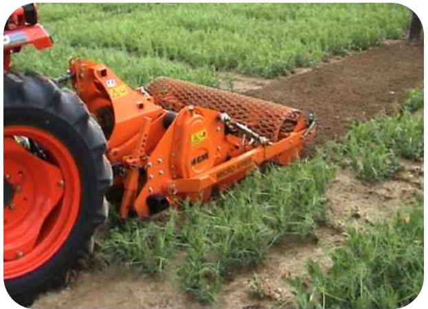
Tracteur 43 cv équipé d'un préparateur de sols
