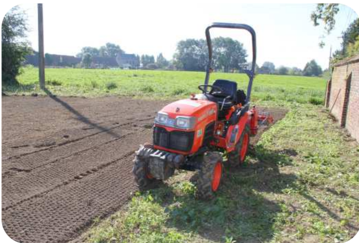
Tracteur 24 cv équipé d'un préparateur de sols
