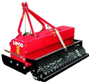
Désherbeur mécanique adaptable sur tracteur
